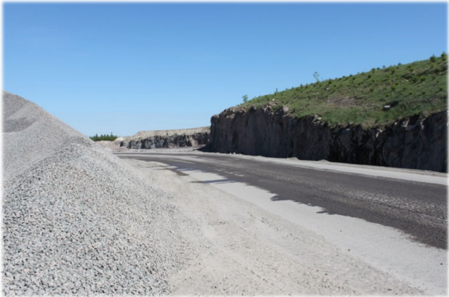
Kuvat 10 ja 11. Kasteltu kiviauton kuljetusreitti. Alueen kiviainestuevarastot on merkitty selkeästi.
