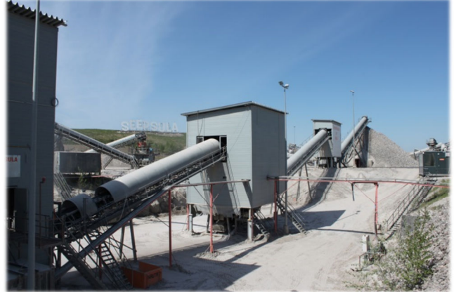
Kuvat 13 ja 14. Syötin, primäärilinjaan koteloidut murskaimet ja seula sekä koteloidut kuljettimet. Kuvassa näkyvissä syöttimen korkeapainekastelujärjestelmä ja korotetut laidat ja kuorman tyhjentämistä odottava kiviauto.
