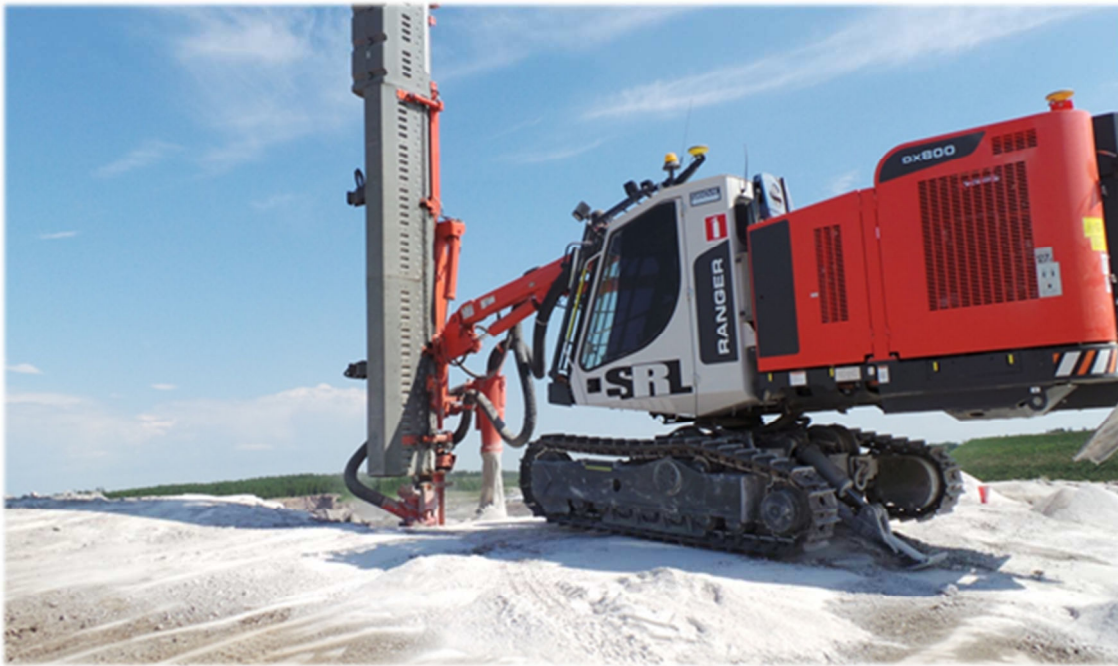
Kuva 12. Poravaunun pölynpoistojärjestelmä ja melukotelo.
