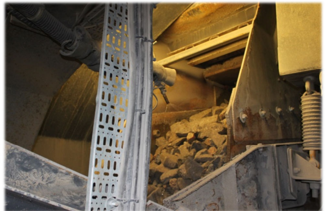
Kuvat 16 ja 17. Tunnelisyöttimen kiviaineskasa ja tunnelisyöttimen kastelujärjestelmä.
