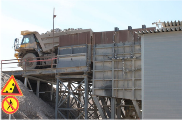
Kuvat 13 ja 14. Syötin, primäärilinjaan koteloidut murskaimet ja seula sekä koteloidut kuljettimet. Kuvassa näkyvissä syöttimen korkeapainekastelujärjestelmä ja korotetut laidat ja kuorman tyhjentämistä odottava kiviauto.
